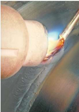
(Şəkil 1) Qızmar doldurucu çubuq ucluğu qoruyucu qaz örtüyü daxilində yaxşıdır.
