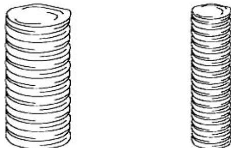
(a) Geniş (toxunuş) qaynaq çıxırını (b) Dar (düz) qaynaq çıxırını
