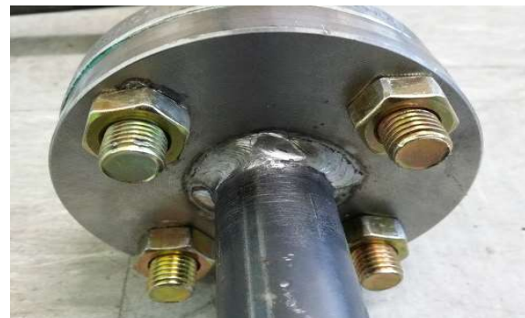
(Şəkil 4) Flans boltun quraşdırılması
