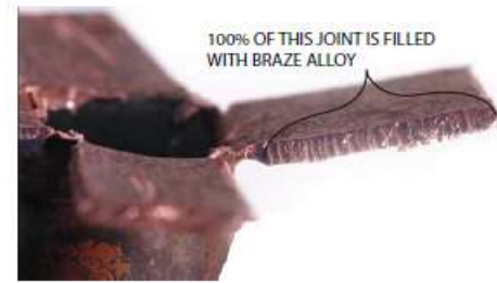
100% of this joint is filled with braze alloy. - Bu birləşmənin 100%-i lehimlə doldurulmuşdur
