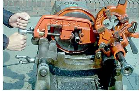
(Şəkil 10) Boru kəsmə işinin metodu
