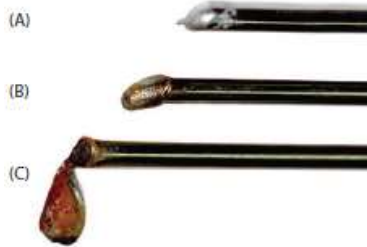
(Şəkil 2) (A) Düzgün şəkildə qorunan doldurucu, (B) doldurucu üzərində bir qədər oksid, (C) doldurucu çubuğun yanlış idarə edilməsi səbəbi ilə yaranan artıq oksidlər əsas materialın qalınlığına bərabərdir.
