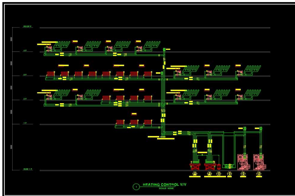
(Şəkil 1) İsti suyun çəkilməsi sxemi
